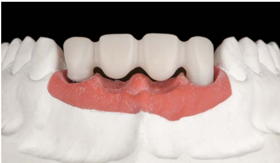
Каркас реставрации был фрезерован из диска диоксида циркония (Kuraray Noritake Katana HT 12) и затем спечен в печи Dekema Austromat 664i при температуре 1500 °C в течение 120 минут в соответствии с инструкциями производителя.
