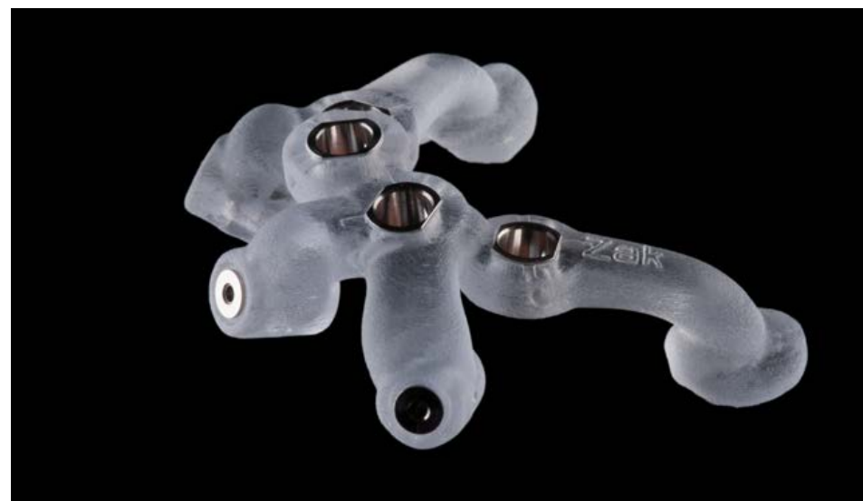
Все втулки были запрессованы в шаблон. Точность прилегания шаблона зависит от метода печати.
