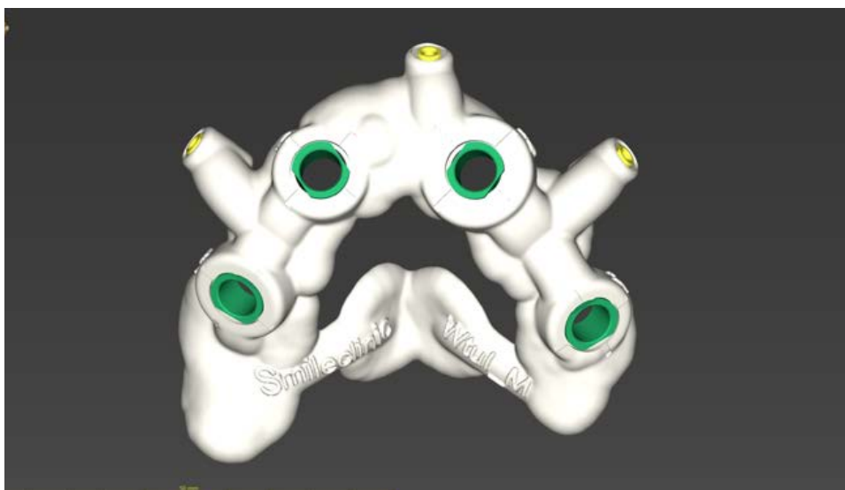
Модель хирургического шаблона экспортируют в формате STL для 3D-печати.
